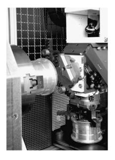
Technologieplattform der MHC PickUp ist die Monforts Werkzeugmaschine DNC 500 DuoTurn. Die präzise, prozesssichere Bearbeitung des eingespannten Werkstückes durch Drehen, Bohren, Fräsen erfolgt über einen oben liegenden Werkzeugrevolver. Neben einer optionalen Stangenbeladung ist ebenfalls die Ausrüstung mit einem vollautomatischen Werkstückbe- und -entladesystem möglich.
